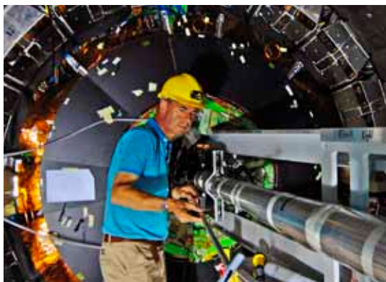
Image. (2): Les composants du détecteur de pixels Barrel en cours d'installation au CERN. (Photo: H.R. Bramaz).
